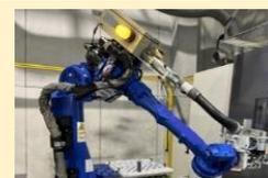
冶金作業自動化ロボット
