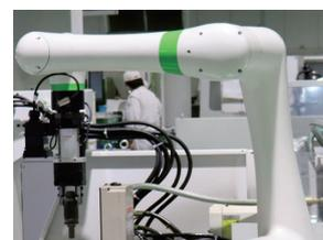
研削加工自動化ロボット
