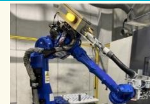
NC旋盤×ワークチェンジャーロボット イメージ
