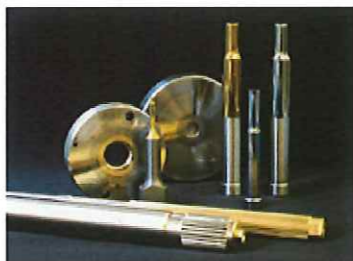
耐摩耗性の高い超硬合金工具は鍛造金型にも使われている
