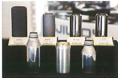
筒状の製缶工具(後列右端)は、粉体を固めた状態(後列左端)から焼結、加工、研磨を経て完成する
