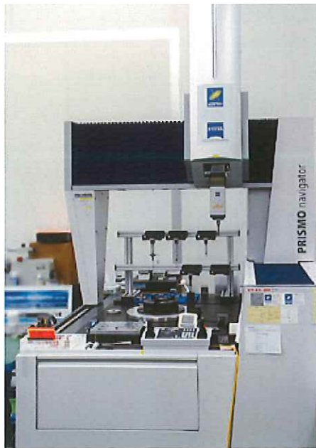
高性能な三次元測定装置を用いて、精密加工製品の品質管理をしている
